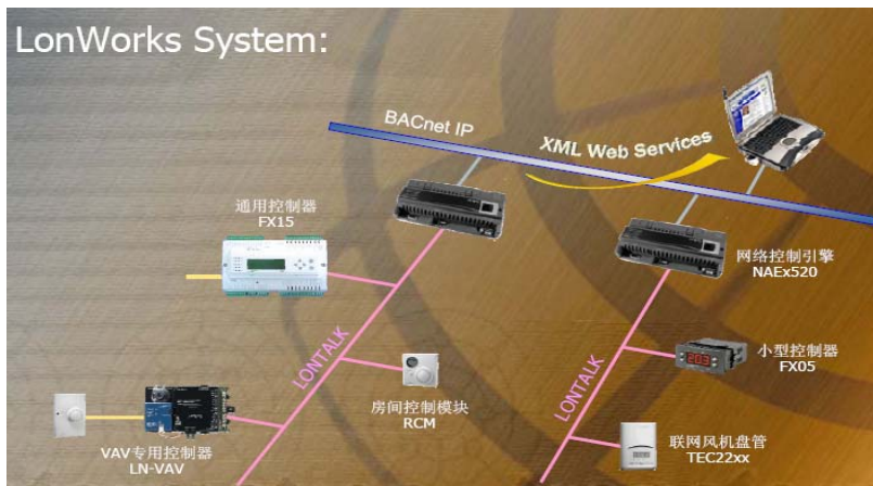
图 3-3 MSEA 系统结构分图—LonWorks 系统
