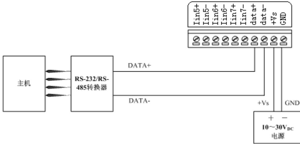
图2 COM-4017I 模块简单控制接线图
