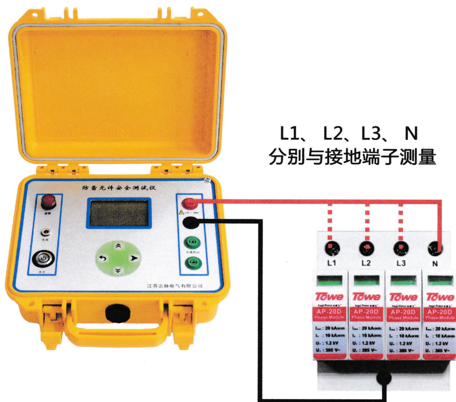
常规电涌保护器测试接线图
