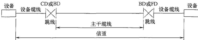
图 3.3.3-2 干线子系统信道连接方式
