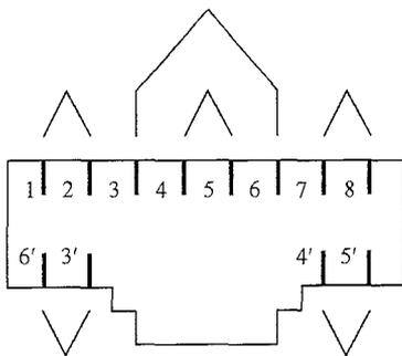
图 6.1.3-2 7 类和 7<sub>A</sub>类模块插座连接(正视)方式 1
