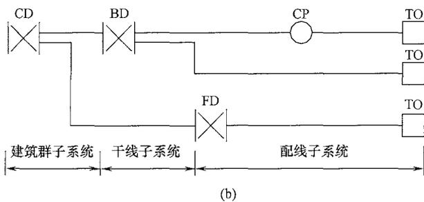
图 3.1.2-2 综合布线子系统构成
