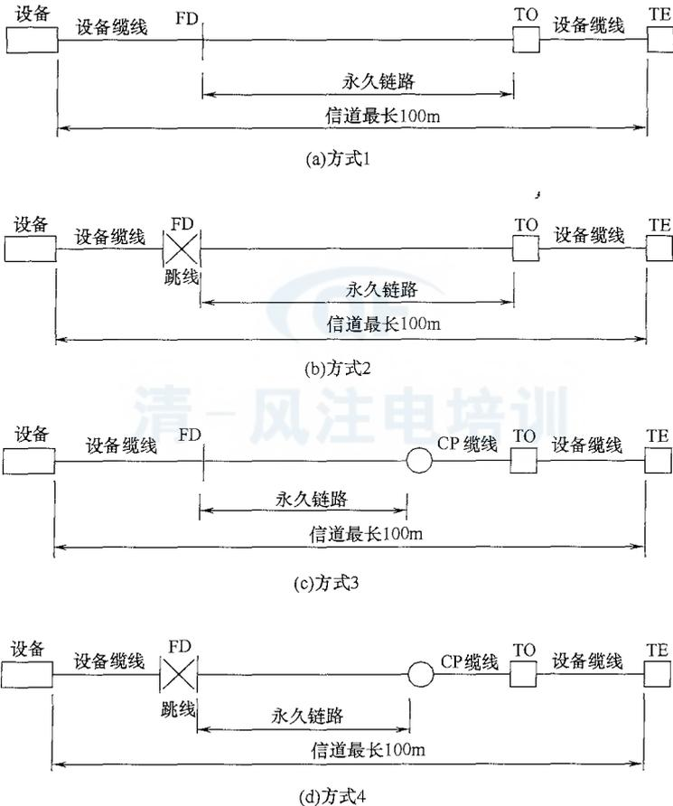
图 3.3.3-1 配线子系统信道连接方式
