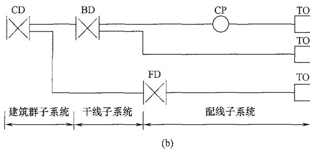
图 3.1.2-2 综合布线子系统构成
