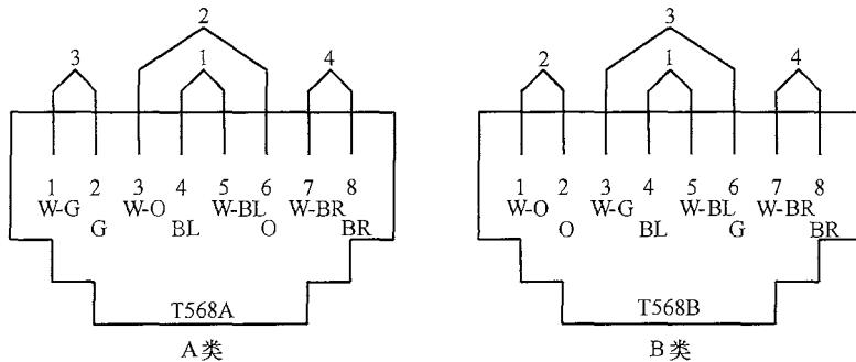
图 6.1.3-1 8 位模块式通用插座连接
