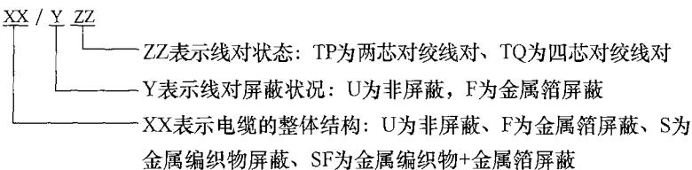
按照此规定,电缆可以分为 8 种类型:U/UTP、F/UTP、U/FTP、SF/UTP、S/FTP、U/UTQ、U/FTQ 及 S/FTQ。
