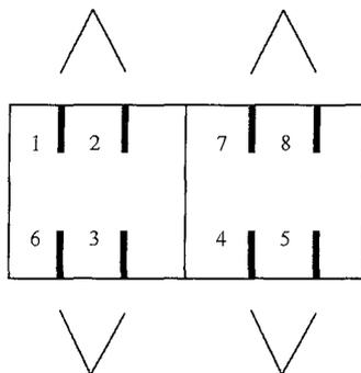
图 6.1.3-3 7类和7<sub>A</sub>类插座连接(正视)方式2
