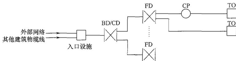
图 3.1.2-3 综合布线系统引入部分构成
