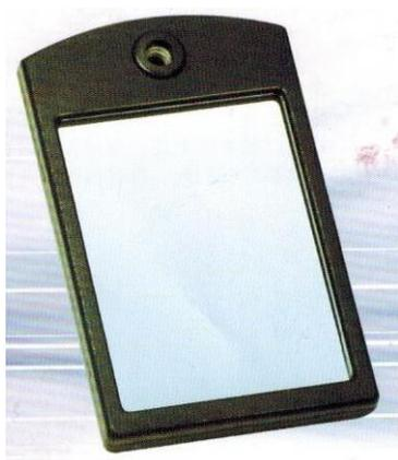
检测建筑物体的上昂头、背面、弯曲面等肉眼不易直接看到的地方，手柄处有 M6 螺孔，可装在伸缩杆或对角检测尺上，以便于高处检测。
