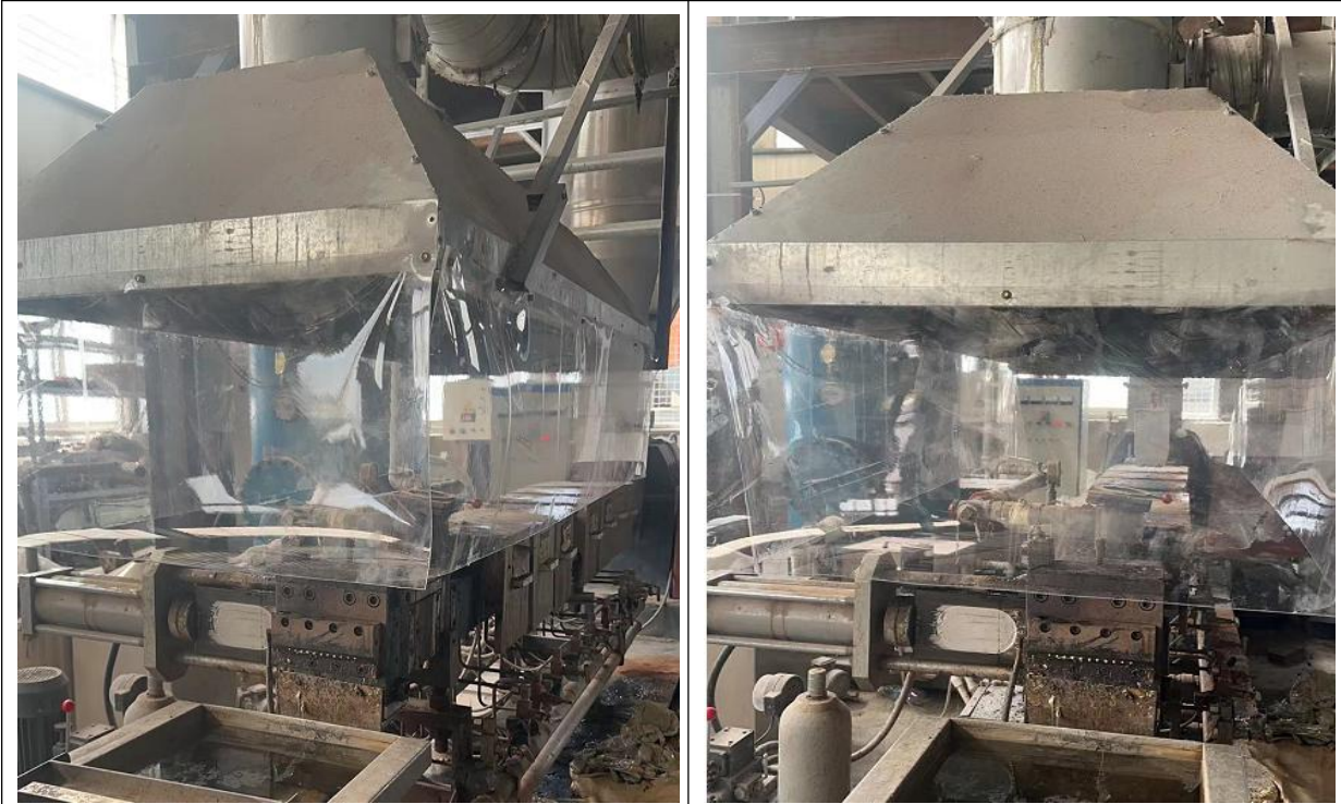
更改后(集气口高度已降低并更换软帘)
