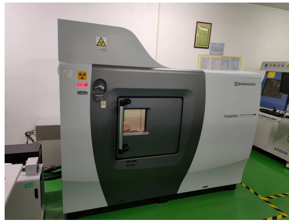
4-1.2 装置正面电离辐射警告标志
