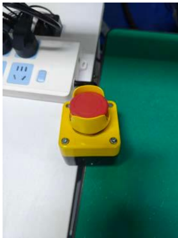
图 3-3.5 操作台台面急停按钮
