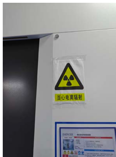
图 3-3.2 工业 CT 正面电离辐射警告标志和中文警示说明
