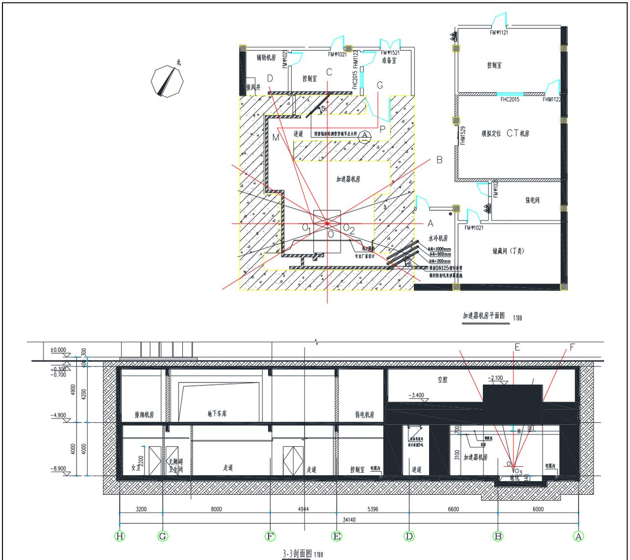
图 11-1 加速器机房关注点和主要照射路径
