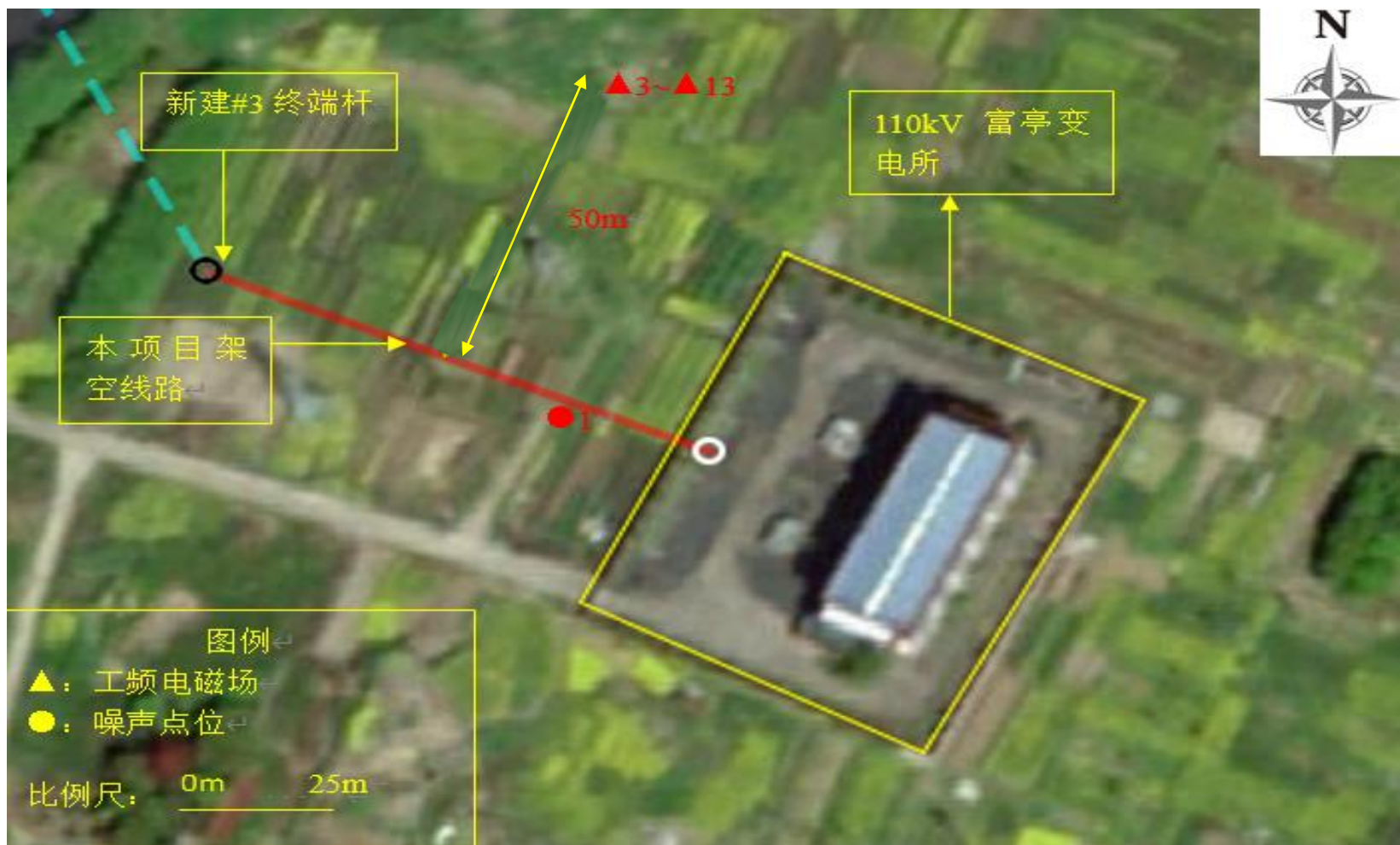
图 7-2 武原街道金星工业园区供电线路迁移项目工频电磁场及噪声监测布点示意图
