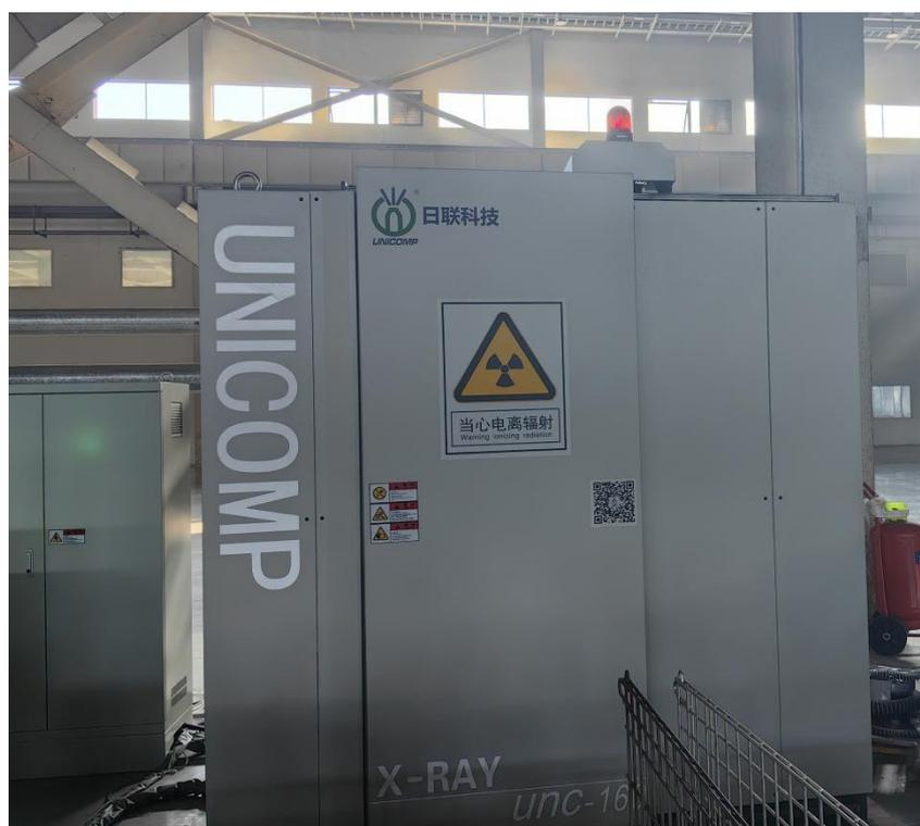
图 9-1 X 射线实时成像检测系统整体外观图
