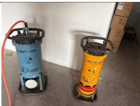
图 2-5 本项目 X 射线探伤机示意图
