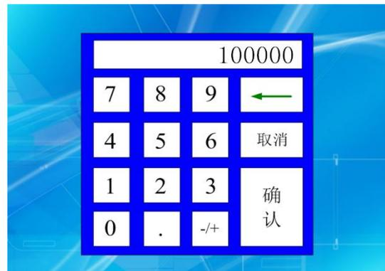
(2) 在测试过程中若测试线断开，仪器显示一下界面，此时请关机检查测试线连接情况，排除问题并重新测量；
