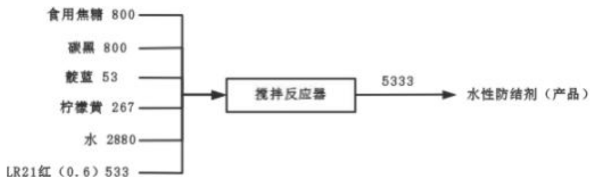
图3.6-3 水性防结剂生产线批次物料平衡图（单位：kg/次）
