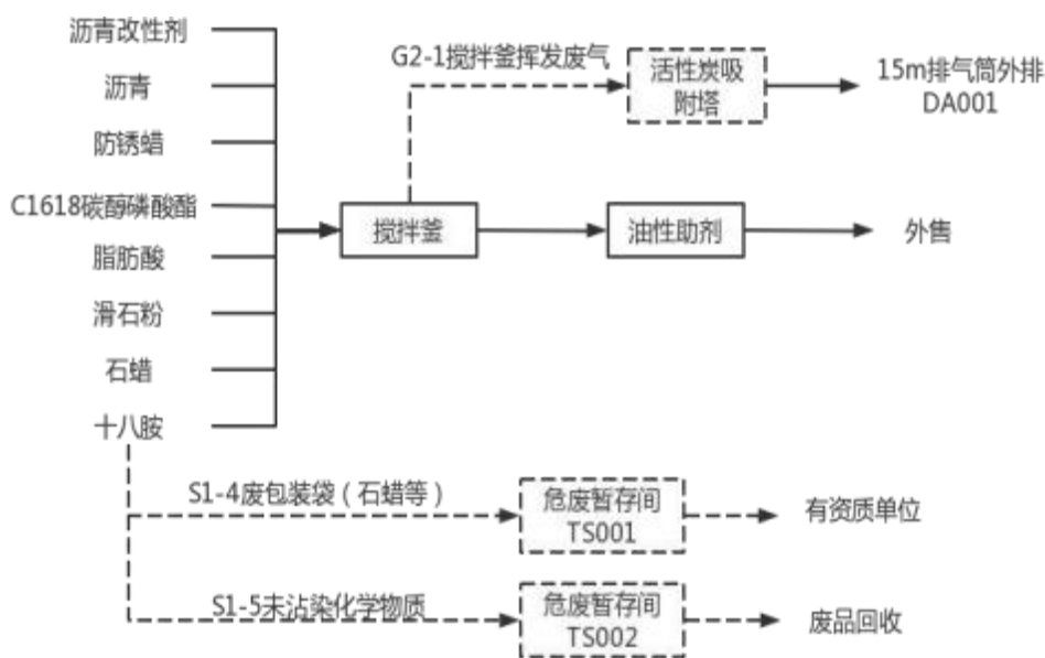
图3.2-2 化肥助剂（油性防结剂）生产工艺流程及产排污图
