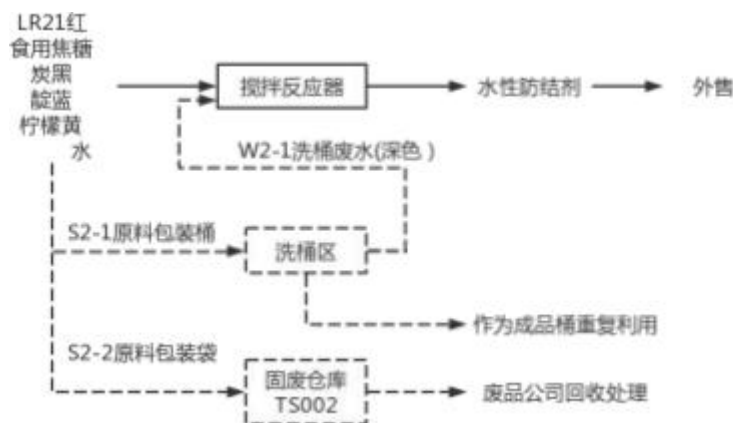
图3.2-3 化肥助剂（水性防结剂）生产工艺流程及产排污图
